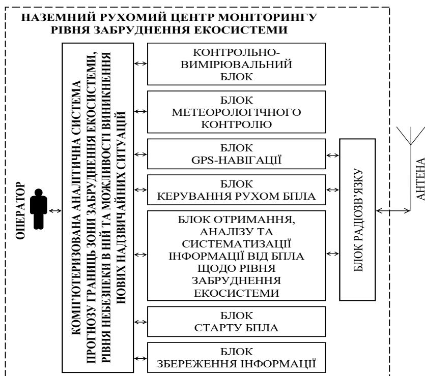
Рисунок 2 – Функціональна схема наземного рухомого центру моніторингу рівня забруднення екосистеми
